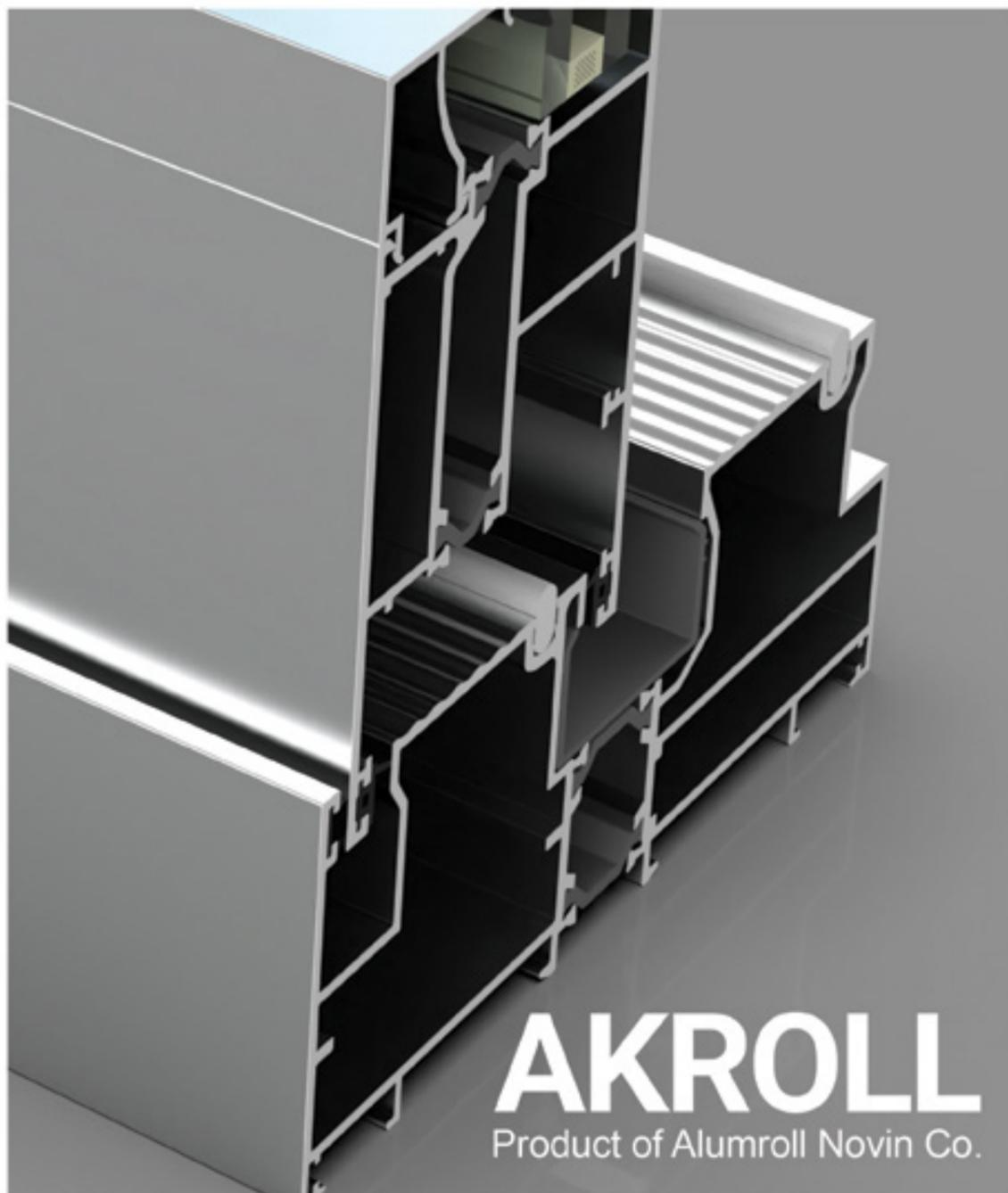
آلومینیوم صرفاً عایق حرارتی و برودتی نمی باشد، از این سو با اضافه کردن تیغه های پلی آمید به ساختار آلومینیوم ، پنجره های ترمال بریک یا به عرصه صنعت ساختمان گذاشتند. سری ۴۰۰ محصولات ترمال بریک با دو سیستم کشویی و لولایی قابل عرضه می باشند که در سیستم لولایی انواع بازوهای تک حالت ، دو حالت ، فولکس واگنی و فولدینگ، قابل اجرا می باشد که در این دو سیستم قابلیت نصب شیشه های دو جداره با ضخامت های مختلف نیز وجود دارد که در حفظ انرژی حرارتی و برودتی کمک بسزایی می کند.
